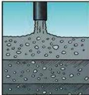
NA BETONAGEM DE ELEMENTOS ALTOS, COLOCAR O BETÃO POR CAMADAS.
